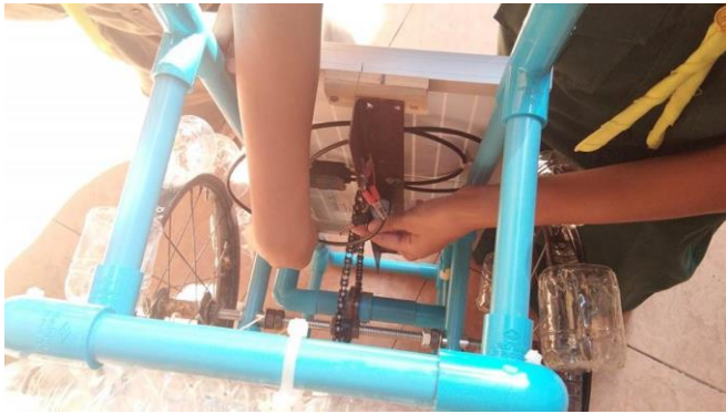
สัปดาห์ที่ 9 ติดตั้งโซ่ตั้งความตึงของโซ่ ต่อวงจร
