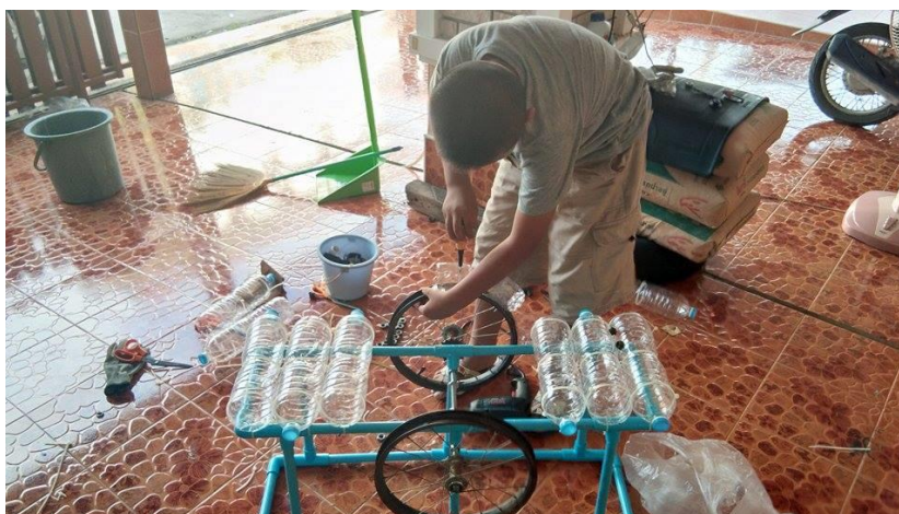
สัปดาห์ที่ 8 ประกอบน็อตกับเฟืองเข้าไปใน stud และ ทำการล็อกล้อ เข้ากับ stud เสร็จแล้วทำการล็อก stud เพื่อป้องกันการโยกซ้ายขวา และล็อกเฟืองเข้ากับ stud ต่อจากนั้นทำการล็อกเฟืองบนและเฟืองล่างให้ตรงกัน
