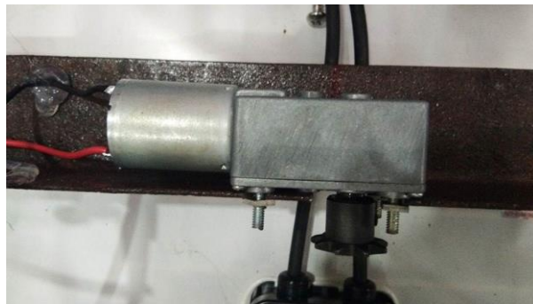
สัปดาห์ที่ 8 ประกอบน็อตกับเฟืองเข้าไปใน stud และ ทำการล็อกล้อ เข้ากับ stud เสร็จแล้วทำการล็อก stud เพื่อป้องกันการโยกซ้ายขวา และล็อกเฟืองเข้ากับ stud ต่อจากนั้นทำการล็อกเฟืองบนและเฟืองล่างให้ตรงกัน
